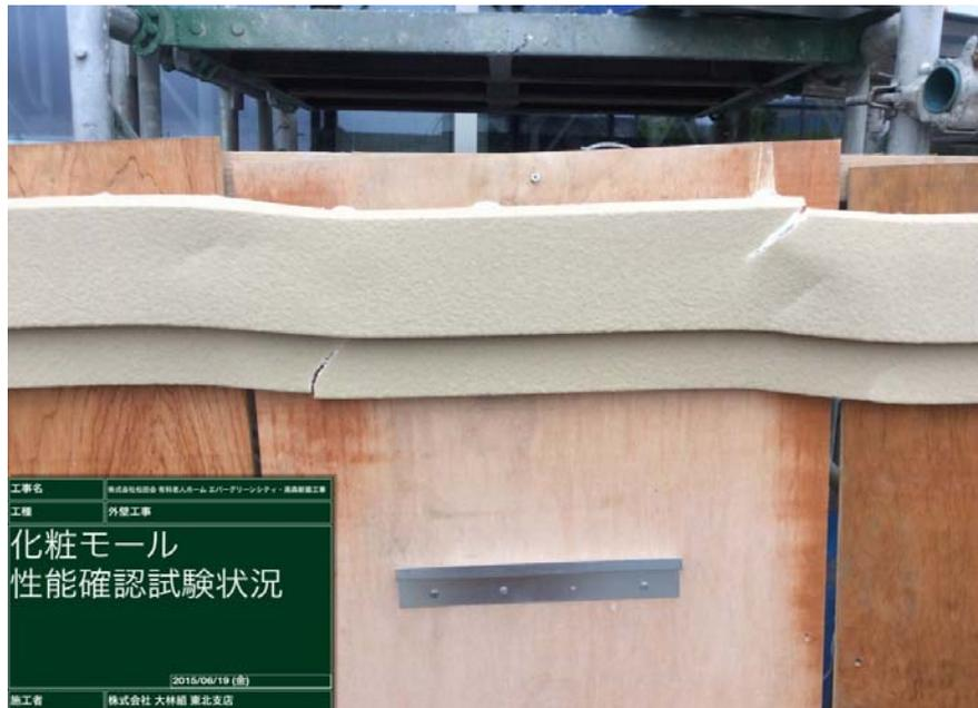
図6. 試験結果（われ収束後）
