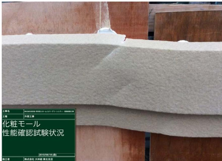
図5. 試験結果（しわ発生直後）
